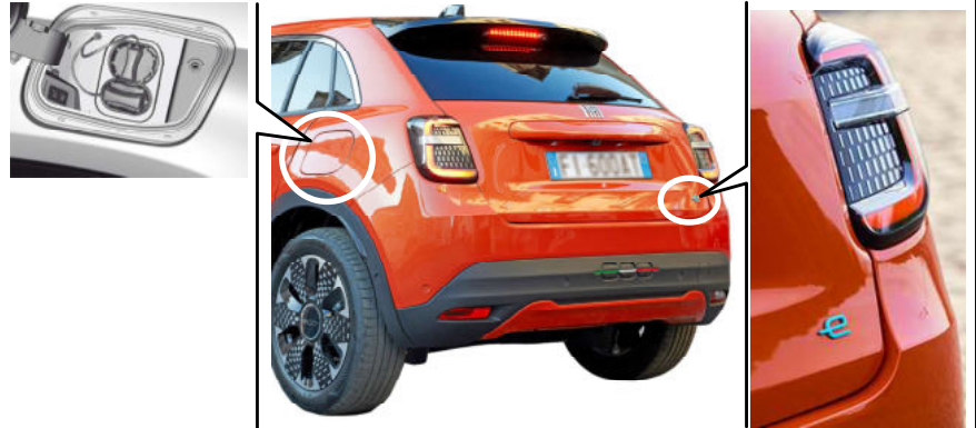
Ladeanschluss im linken Kotflügel
